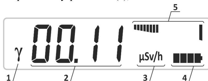
Рисунка 11 - ТКИ на дозиметъра (измерване на МЕД от фотонно йонизиращо лъчение в точен режим)
