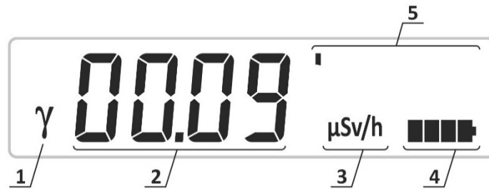
Рисунка 10 - ТКИ на дозиметъра (измерване на МЕД от фотонно йонизиращо лъчение в режим на търсене)
