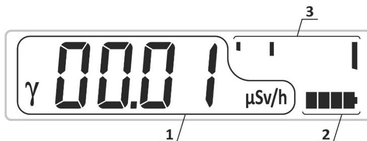
Рисунка 15 - ТКИ на дозиметъра (преглед на историята на измерванията, изобразяване на резултата от измерването)
